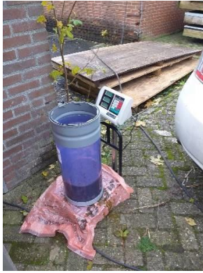
Foto's 1 en 2. Pot met weeginrichting en gevulde pot juist voor aanvang van de metingen.
