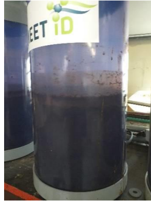
Foto's 1 en 2. Pot met weeginrichting en gevulde pot juist voor aanvang van de metingen.
